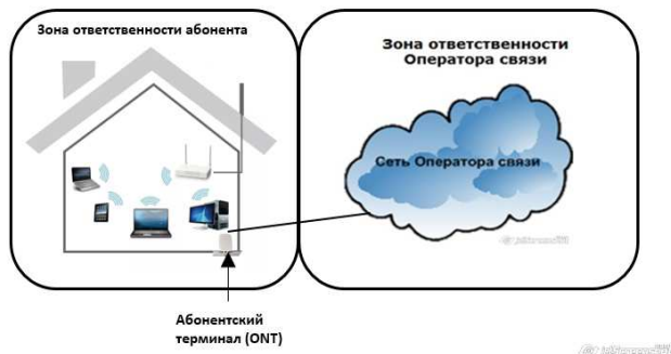
СХЕМА ВКЛЮЧЕНИЯ ПОЛЬЗОВАТЕЛЬСКОГО (ОКОНЕЧНОГО) ОБОРУДОВАНИЯ ПО ТЕХНОЛОГИИ xPON
